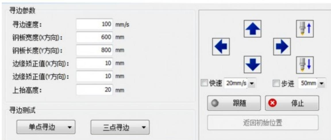
电容寻边需要设置一些参数。寻边速度对寻边精度有影响#推荐设置值为200mm/s#钢板宽度为钢板在机床X轴方向的长度#钢板长度为钢板在机床Y轴方向的长度#边缘矫正值用于矫正寻边结果#正数表示将激光头向板内偏移#负数表示将激光头向板外偏移#上抬高度为寻边过程中切割头上抬的高度。
