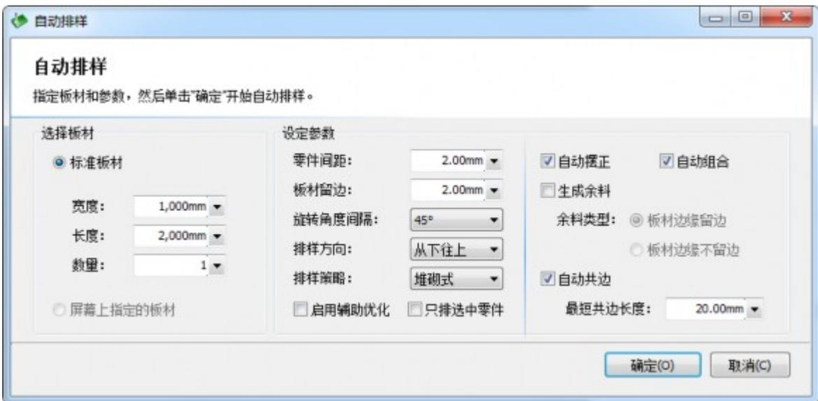
**排样策略** 是指程序计算排样结果时使用的策略#自动排样目前提供了五种策略# 搜索式#按照待排空间的轮廓搜索形状相匹配的零件排入#排样结果零件之间比较紧密。堆砌式#该排样策略零件占据空间的高度平均增长#排样结果零件所占据空间的高度较低较平均#可生成较大的矩形余料#阵列式#较少种类零件阵列排入板材#尤其是单一零件的排样推荐使用该策略#矩形式#零件按照矩形式排布#同种零件组成矩形块#排样结果局部和整体较为整齐#适合类矩形的排样#顺序式#将零件从大到小地排入板材。排样后的图形也将有一定的优化选项#勾选 **启用辅助优化** 将会对排样后的图形自动进行一次优化#但同时也会消耗更多的时间#您可根据实际情况自行选择#**自动摆正** 将会对姿态歪斜的零件先摆正再排样#**自动组合** 将会自动分辨出形状互补的零件耦合起来进行排样#可提高排样速度与零件排布整齐性#若勾选了 **自动共边** #则需要设置自动共边的最短长度 #当图形共边线长度大于该值时才会执行自动共边 #注意# 此功能不能和 **启用辅助优化** 同时使用。排样后图形如下所示#
