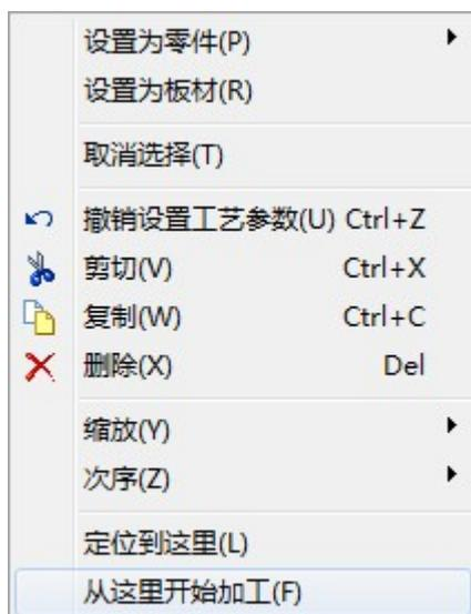
为安全起见#选择**从这里开始加工**后#软件将弹出对话框要求再次确认#确认无误后切割头将首先空移到您指定的位置#然后从那里开始加工#所指定位置之前的轨迹将不会被加工。
