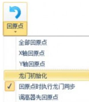
在完成龙门初始化以后勾选上**回原点时执行龙门同步**#输入密码确认。相关补偿信息会显示在软件的系统消息窗口。
