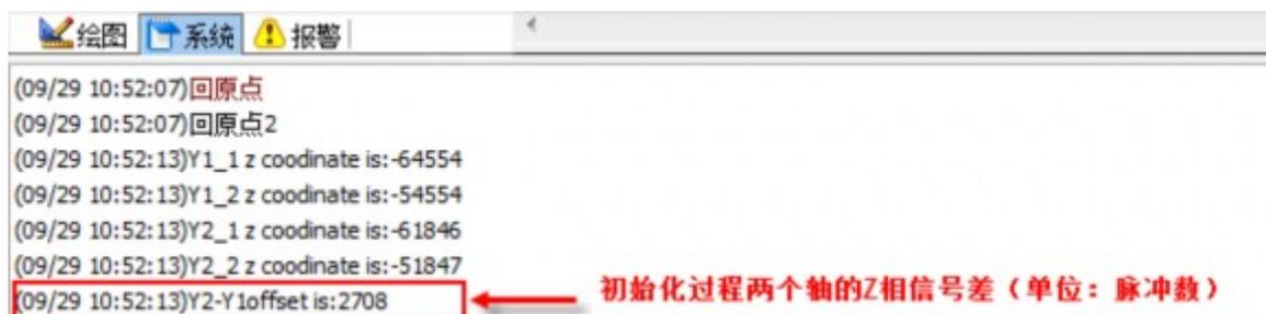
完成龙门初始化后勾选上**回原点时执行龙门同步**#输入密码确认。选中后执行**回原点**或者**Y轴回原点**过程时将检测Y1和Y2轴的Z相信号值#计算出偏差并且进行补偿#Z相信号和补偿值#Y2 compensate#也会显示在软件的系统消息窗口。
