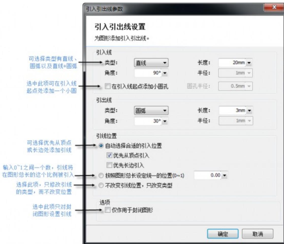
支持的引线类型包括圆弧和直线以及直线加圆弧#支持的参数包括引线类型、角度、长度和半径。您也可以选择是否在引入线起点加入小圆孔。
