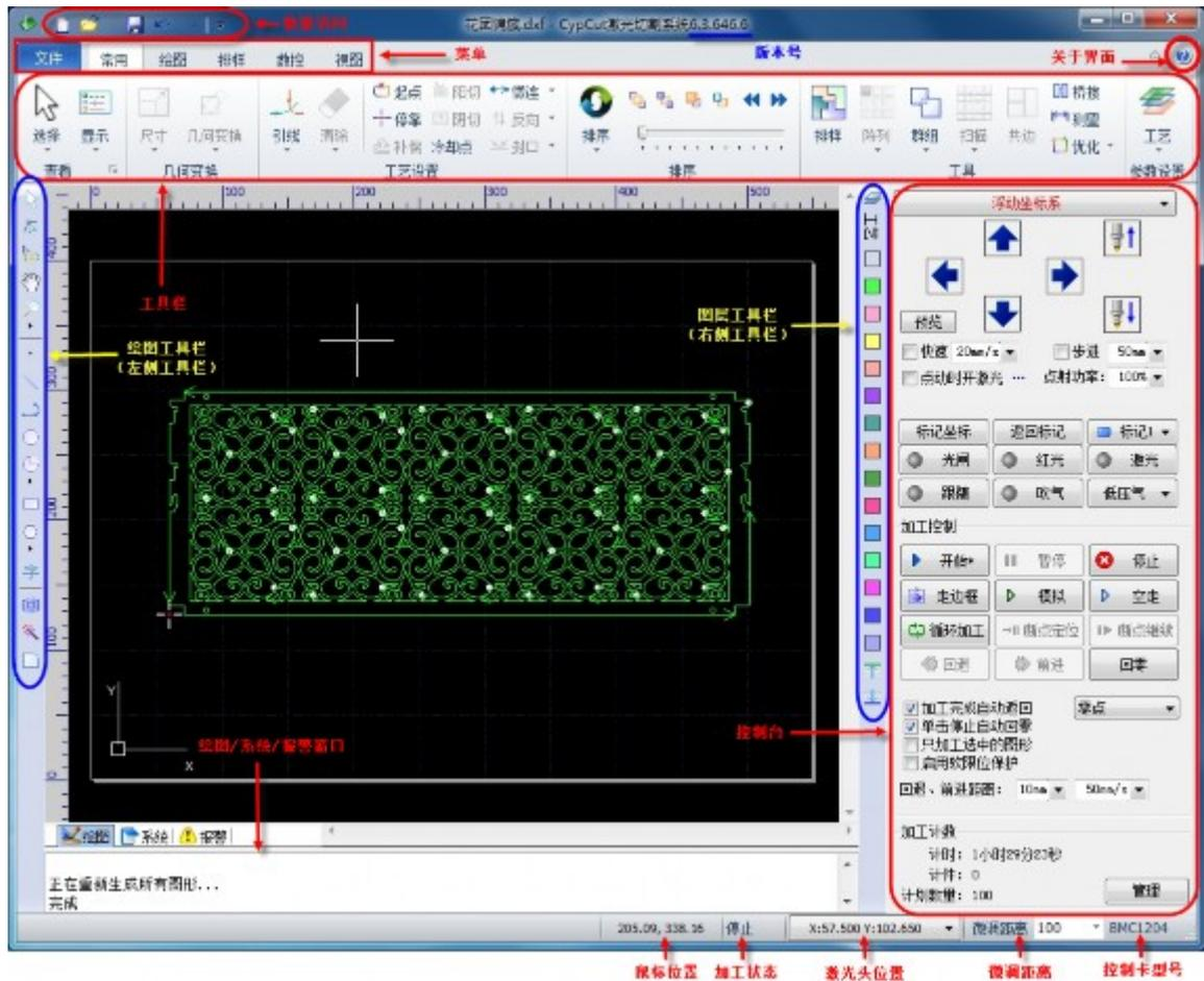
界面正中央黑底的为绘图板#其中白色带阴影的外框表示机床幅面#并有网格显示。网格与绘图区上方和左侧的标尺会随视图放大缩小而变化#为绘图提供参考。
