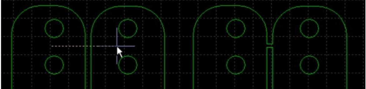
桥接需要指定两个参数#第一个参数指定相邻曲线之间的最大距离#当两个图形之间的距离小于指定数值时才进行桥接#第二个参数指定桥接的宽度。
