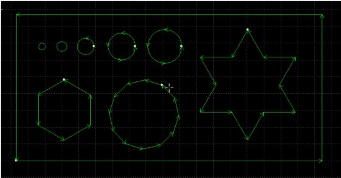
在不影响精度的情况下#尽可能的调高低滤波频率。要求切割矩形#多边形#星形图案时#拐角前后都不产生波浪。可以按照以下表的经验值来设置。或先确定好加工加速度后#把低滤波频率在上下2级范围内调试。加工加速度和低滤波频率这2个参数必须要匹配#千万不要把这2个参数中某个值调的很大#另一个值调的很小。
