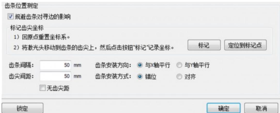
勾选**规避齿条对寻边的影响**后#可以设置齿条间隔、齿条间距、齿条安装方向、齿条安装方式#进而规避齿条对寻边的影响。启用此功能时#必须先标记齿尖坐标。**齿条间隔**为相邻齿条的间隔#**齿尖间距**为相邻齿尖的距离#**齿条安装方向**为齿条的安装位置与机床的相对关系#**齿条安装方式**是选择错位安装或对齐安装#**无齿尖距**是在齿条既不是对齐安装也不是错位安装下的设置。
