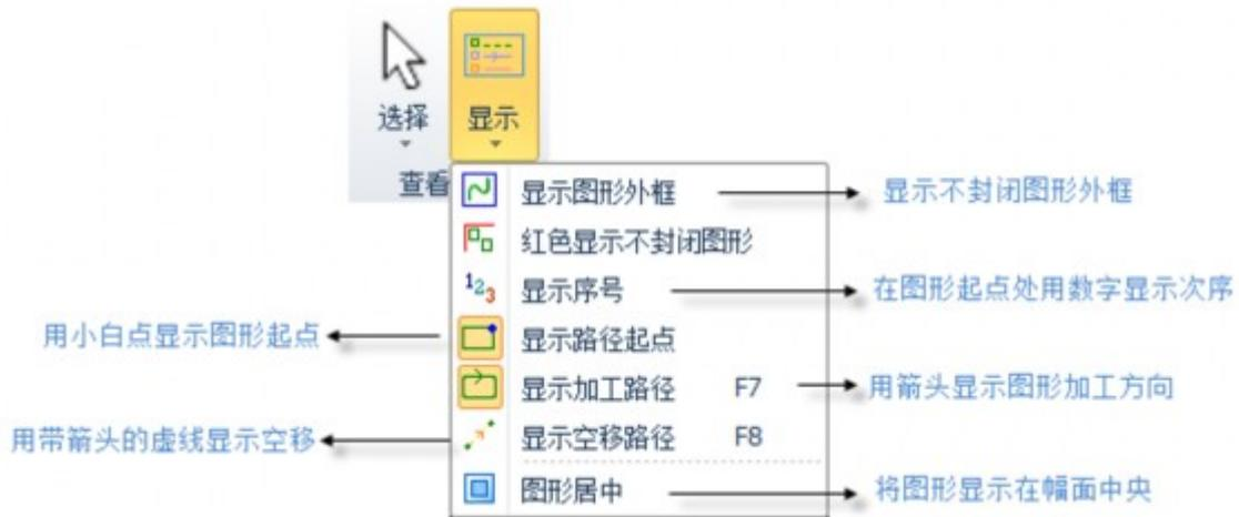
单击上图中的按钮#显示效果立即生效#您可以在绘图板中看到显示效果的变化。请注意按钮本身的显示变化#淡黄色底色时为开启状态#表示对应效果已开启#没有淡黄色底色则表示对应显示效果尚未开启。例如#开启状态#绘图板上用箭头显示图形加工路径#关闭状态#图形上的箭头消失。
