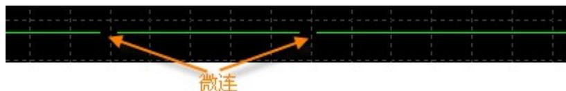
单击工具栏上的**微连**按钮#然后在需要加入微连的图形处单击就可以添加一个微连#您可以连续单击来插入多个微连#直到按下ESC取消或切换为其他命令。您不仅可以在图形上单击#也可以在经过补偿后的轨迹上单击来插入微连。
