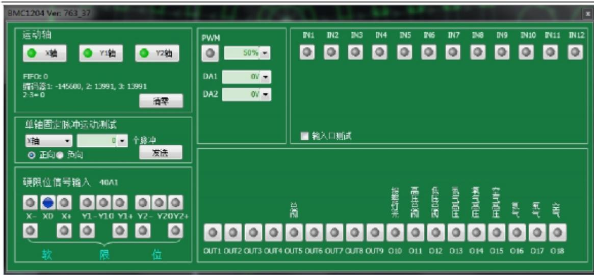
运动轴显示了各轴信号及相应编码器反馈值#单轴固定脉冲运动测试用以向单轴发送固定脉冲以测试脉冲当量是否准确#限位信号用以显示切割头是否撞到限位#PWM用以显示激光开关情况#还显示了12个输入及18个输出的有效情况。
