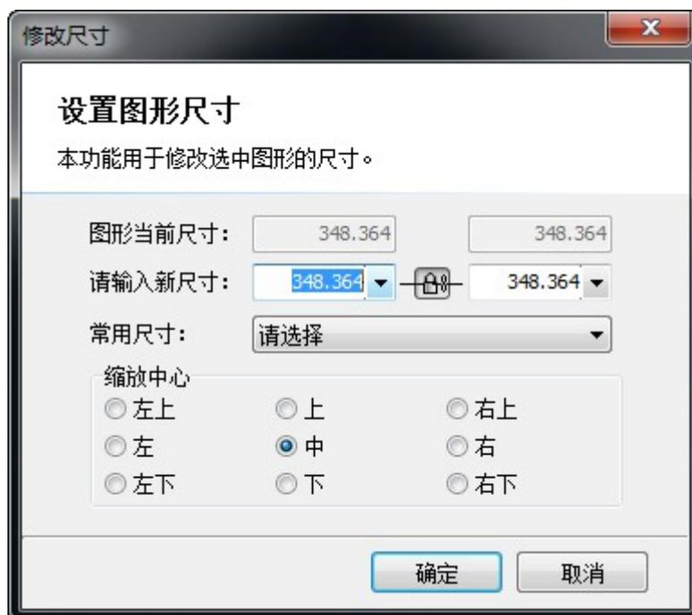
当界面中锁的状态为时#长度和宽度是按原图尺寸比例锁定的#如果希望单独输入长度和宽度#点击按钮可以解除锁定状态#按钮变为状态。
