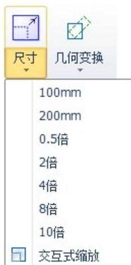
例如 100mm 将图形等比例缩放为宽度 100mm#2 倍将图形等比例放大 2 倍。
