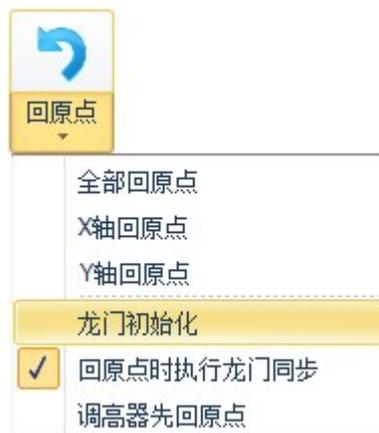
输入密码确定以后机床会回原点#之后龙门轴会向正方向运动找到两个Z相信号。动作完成以后#在软件下方的系统消息窗口会显示Z相信号的位置和两个轴的Z相信号差#Y2-Y1 offset##
