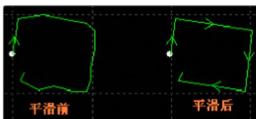
右图为原有的曲线和曲线平滑后的曲线对比。为便于观察效果#这里输入的拟合精度数值较大#实际使用时请用户根据自己需要的加工精度进行拟合。
