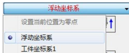
浮动坐标系一般用于非正式加工#可认为激光头移动到哪里就从哪里开始加工#其坐标系零点在用户在点击**走边框**#**空走**或者**加工**时自动设置为激光头当前位置。
