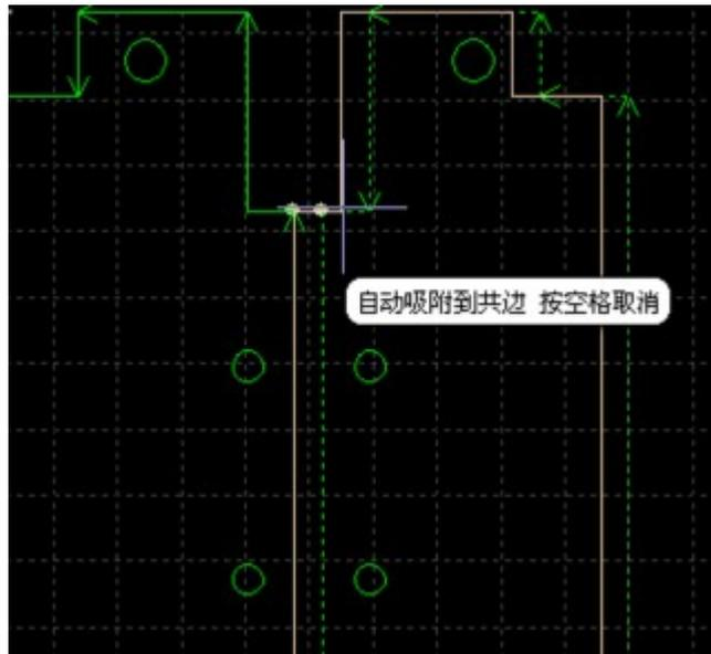
一旦将两个图形靠在一起且具有相同的边界#只需选中它们并按下 **共边** 按钮即可完成共边。如果您希望对已共边的零件拆开来继续编辑#或者是设定它们的次序#请选择零件#然后单击常用菜单栏下的 **打散**#编辑完成之后可以通过 **群组** 按钮再次合并它们。
