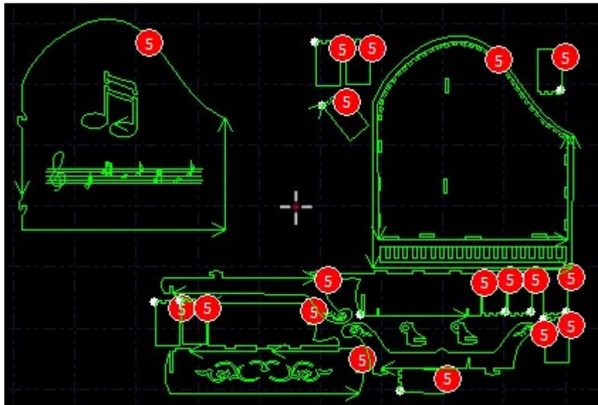
自动排样需要设置一些参数。**零件间距** 指零件与零件之间会留出不小于设置大小的间距# **板材留边** 参数指定了零件排样留出的板材边框#**旋转角度间隔** 指排样时对零件进行旋转调整的角度#对于不允许零件与板材间有相对旋转的情况请选择 **禁止旋转**#**排样方向** 指的是希望零件靠贴板材的哪一个方向。
