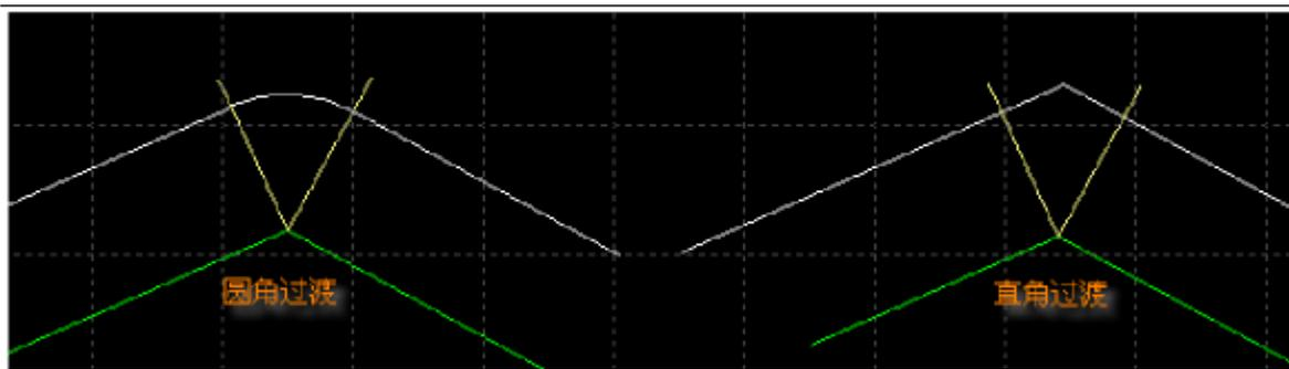
图中绿色为原图#白色为补偿后的轨迹#淡黄色为从原图拐角处所作的垂线。从图中可以看出垂线两侧补偿之后可以保证割缝边缘与原图重合#但拐角处则需要过渡。通常圆角过渡能保证在过渡过程中割缝边缘仍然与原图重合#并且运行更加光滑。
