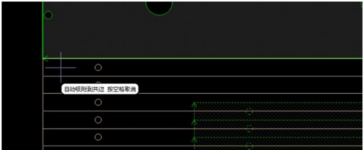
接下来#选择所有图形#就可以把所有的零件1#零件2#零件3都共边了。如果不希望零件2#零件3与零件1共边#那么可以省掉这个步骤。当然#零件 2和零件3也应该稍微拖动到离开零件1的边界。将图形拖动离开共边的边界时#为了避免自动吸附#可以按一下空格键#自动吸附功能就会暂时失效。下次拖动时自动重新生效。
