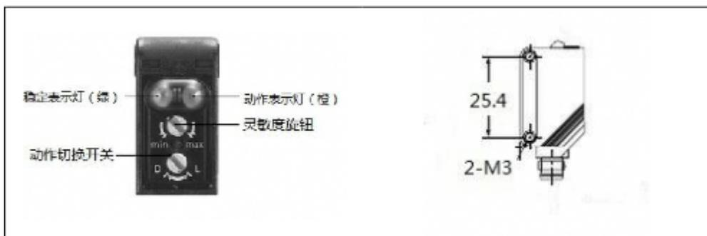
该光电开关有效工作范围为 $90\pm 30\text{mm}$ #安装螺纹为M3#该开关可以切换两种动作模式#L表示光电开关有信号输出时橙色指示灯亮#D表示光电开关有信号输出时橙色指示灯暗#旋转灵敏度旋钮可改变光电开关的灵敏度。
