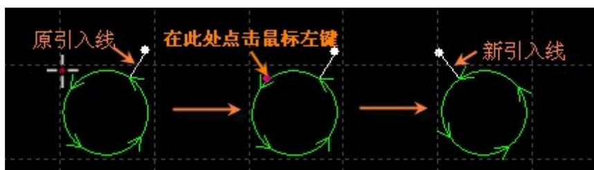
先在图形外单击#点A#黄色的点##然后在图形上单击#点B#红色的点##则表示从图形外到图形上画一条直线引入。
