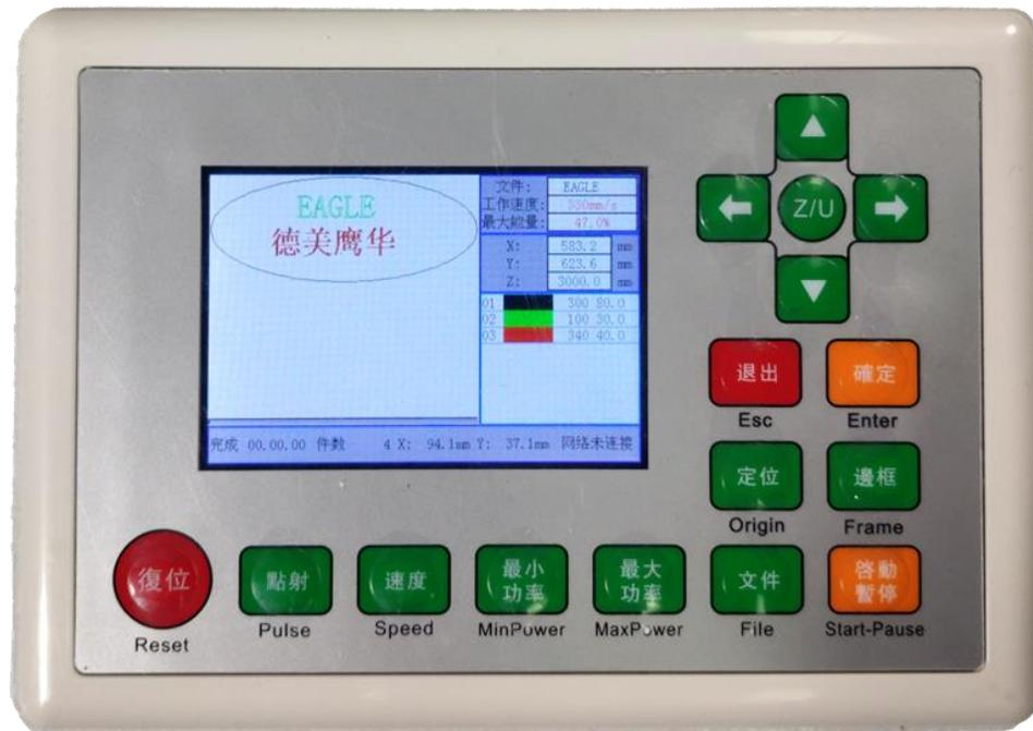
EagleCAM 控制系统的操作面板由一块彩色显示屏和一系列操作按键组成。显示屏用于显示控制系统的功能、操作和状态等信息，按键用于完成各项操作。
